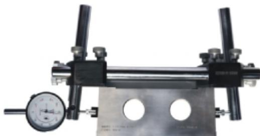
图26 (顶径标准块校准C10)
